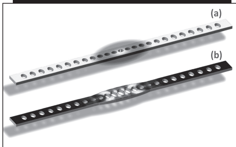
Fig. 3 A figura representa de forma exagerada a distensão que ocorre na região central da nanoviga
