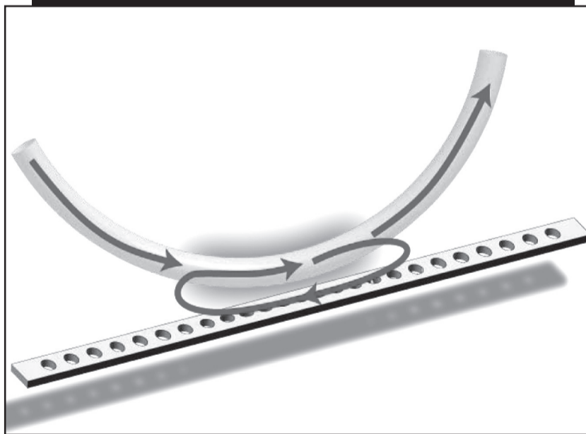
Fig. 2 A luz que chega e sai da nanoviga é conduzida através de uma fibra óptica
